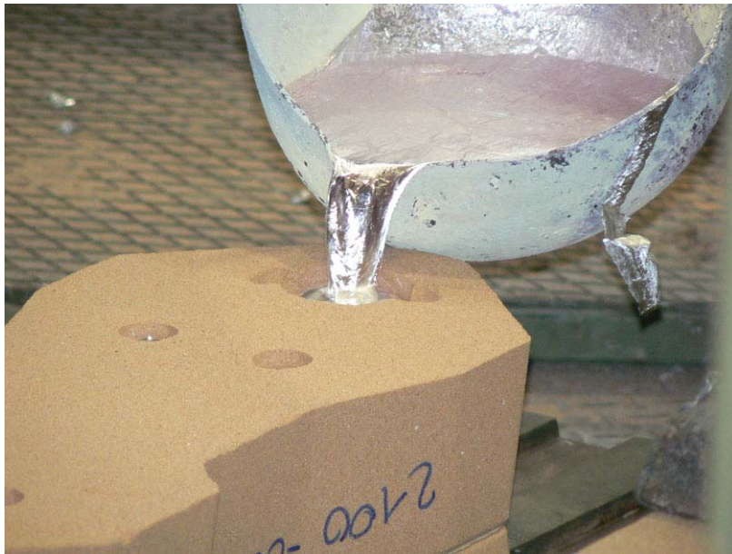
FIGURA 2.22 Processo di colata
