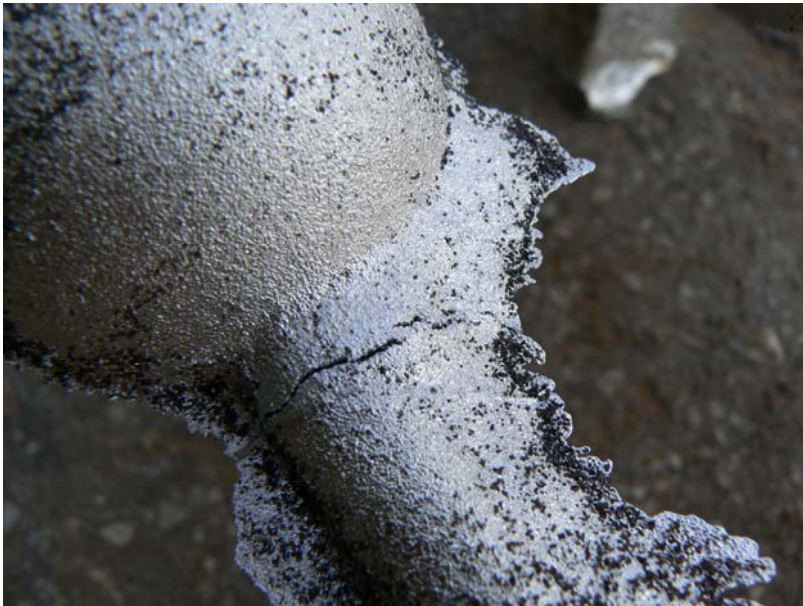
FIGURA 5.22 Dettaglio su esteso danneggiamento del getto
