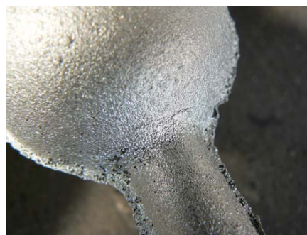
FIGURA 3.2 Esempio di barra leggermente criccata
