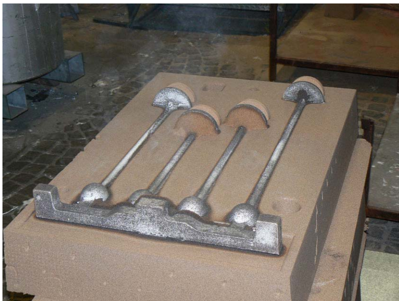
FIGURA 2.23 Apertura stampo dopo raffreddamento del getto
