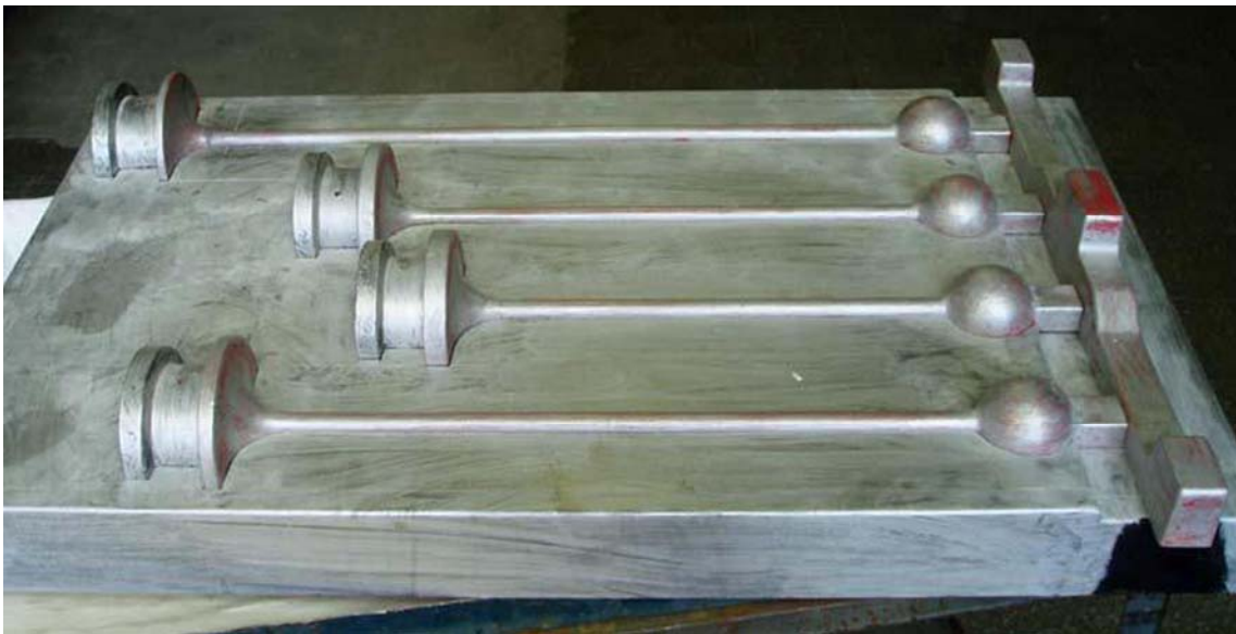
FIGURA 2.17 modello in legno inserito nella placca-modello. Il colore grigio è dovuto al distaccante con cui sono stati ricoperti i due componenti, allo scopo di migliorare il successivo distacco dalla terra.
