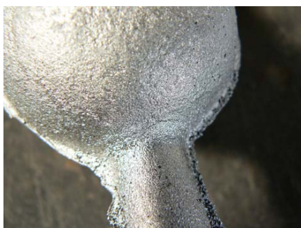
FIGURA 3.3 Esempio di barra criccata
