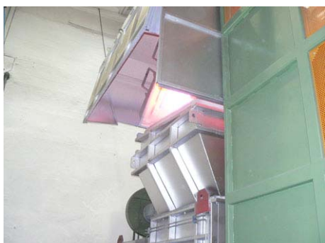
FIGURA 2.19 Forno fusorio a bacino a gas
