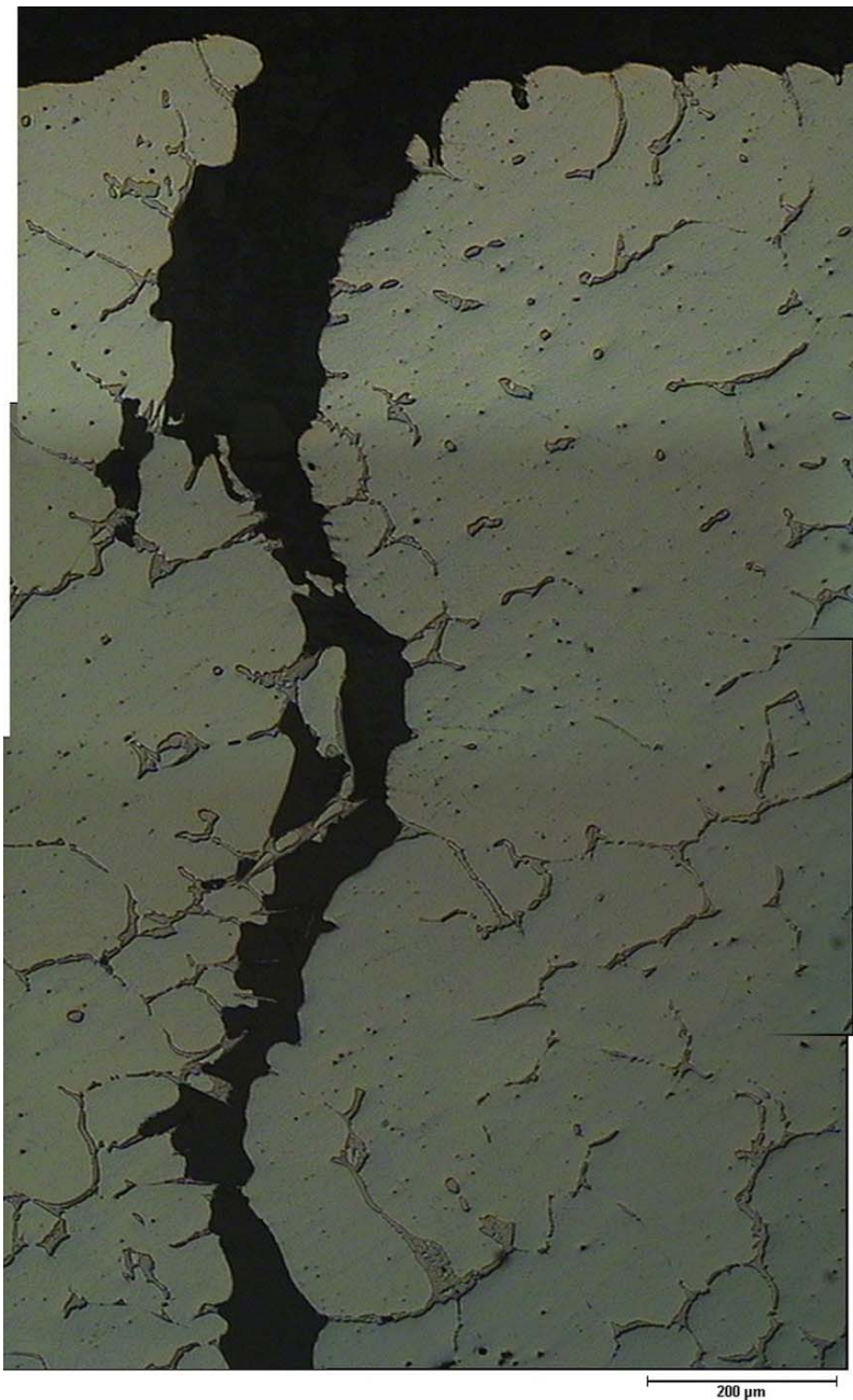
FIGURA 4.16 Frattura intergranulare su composizione di micrografie, ottenute a 100x
